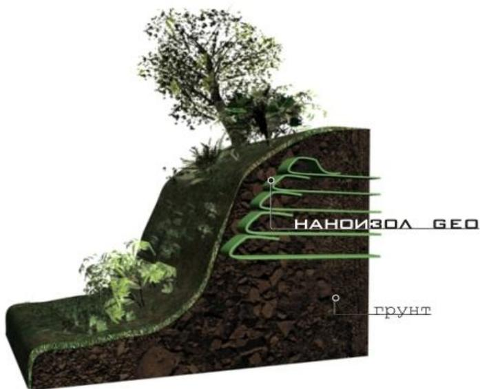
Технология применения данных материалов дает значительную экономическую выгоду в сравнении с такими традиционными методами, как строительство бетонных подпорных стен, шпунтовых ограждений, замена грунтов (при строительстве на слабых основаниях). Для армирования асфальтовых покрытий применяются геосетки, композиционные материалы на их основе и полимерные волокна (дисперсное армирование).
