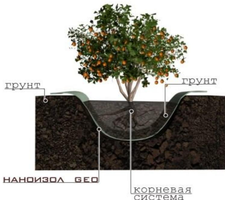
Геотекстиль Наноизол GEO 80 используется для ограждения роста корней растений, предотвращает прорастание корней в дренажные трубы, насыпные цветочные клумбы.
