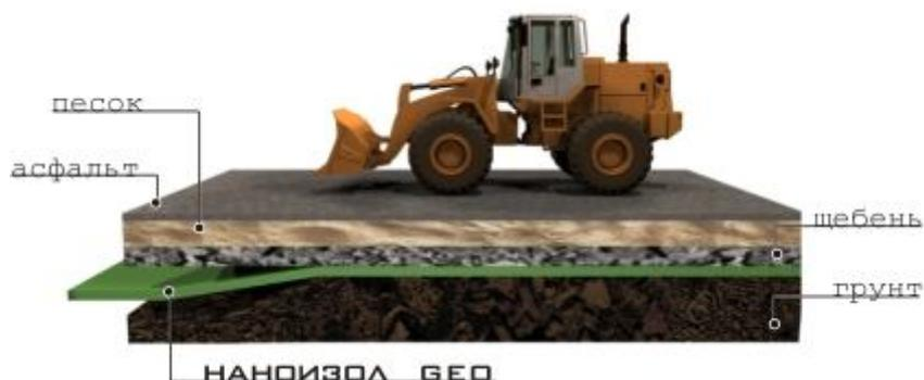
В дорожном строительстве Наноизол GEO применяется для устройства откосов повышенной крутизны, подпорных стенок, усиления оснований дорожных насыпей, а также для защиты конусов путепроводов, армирования асфальтовых покрытий, разделения конструктивных слоев дорожной одежды и в качестве элементов дренажных систем.
