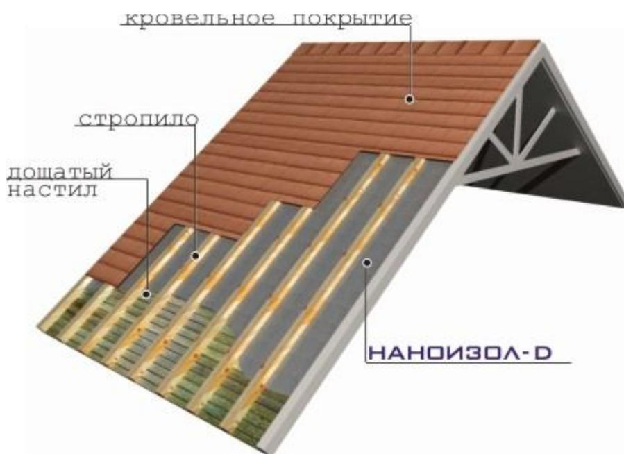
Гидро-пароизоляция «Наноизол D» укладывается на обрешетку или настил из досок гладкой стороной наружу. Монтаж ведется с нижней части крыши с перекрытием полотнищ не менее 15-20 см. Крепеж материала к обрешетке производится степлером, либо деревянными рейками. Для обеспечения гидро-пароизоляции полотнища необходимо скрепить между собой лентой. Использование в конструкции кровельных уплотнителей значительно продлит срок службы всей кровли.
